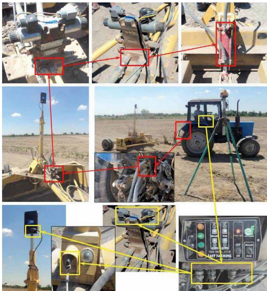
Рис. 6. Порядок подсоединения гидравлики и автоматики. Красным отмечены части для подсоединения шлангов, желтым отмечены части для подсоединения автоматики. Панель управления питается от аккумуляторной батареи трактора (не показан на снимке).
