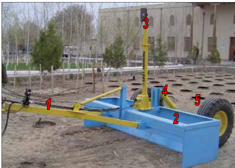
Рис. 3. Основные части лазерного планировщика: 1 – прицепная рама; 2 – ковш; 3 – мачта для лазероприемника; 4 – гидроцилиндр и шланги; 5 – колесо и рама.
