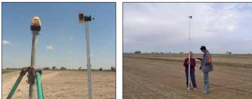
Рис. 4. Лазерный передатчик и ручной лазерный приемник прикрепленный к телескопической линейке. На размеченных точках оператор считывает показания на линейке, когда прикрепленный лазерный приемник начинает издавать сигнал улавливания лазерного луча от передатчика.
