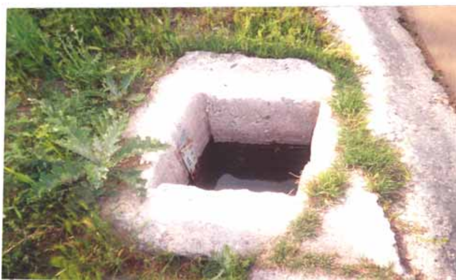
Рис. 10. Средства измерения уровня воды а) гидротехническая рейка б) успокоительный колодец
