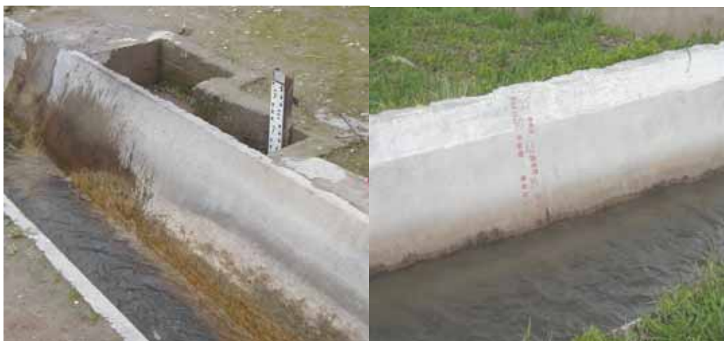
Рис. 8. Градуированный параболический лоток а) с успокоительным колодцем б) с расходомерной шкалой
