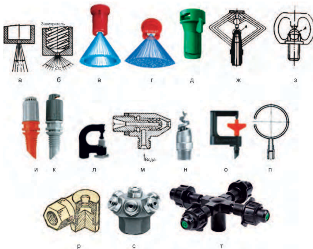
Рис. 6.16. Типы форсунок: а – струйная ( 2\alpha = 10 - 15^\circ ); б – центробежная с завихрителями ( 2\alpha = 50 - 110^\circ ); в – струйная с полым коническим факелом; г – струйная с плоским факелом; д – струйная с боковым факелом; ж, з, и, к, л – струйные с отражающим дефлектором; м – центробежная с завихрителем и подсосом воздуха; н – струйная с завихрителем; о – с разбрасывающим диском; п – струйная с соударяющимися струями; р – тангенциальная; с, т – фоггер (блок насадок)
