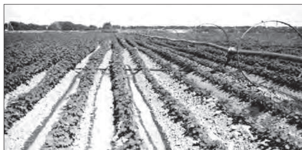
Рис. 9.8. Колёсный трубопровод для полива по бороздам ТКП-90
