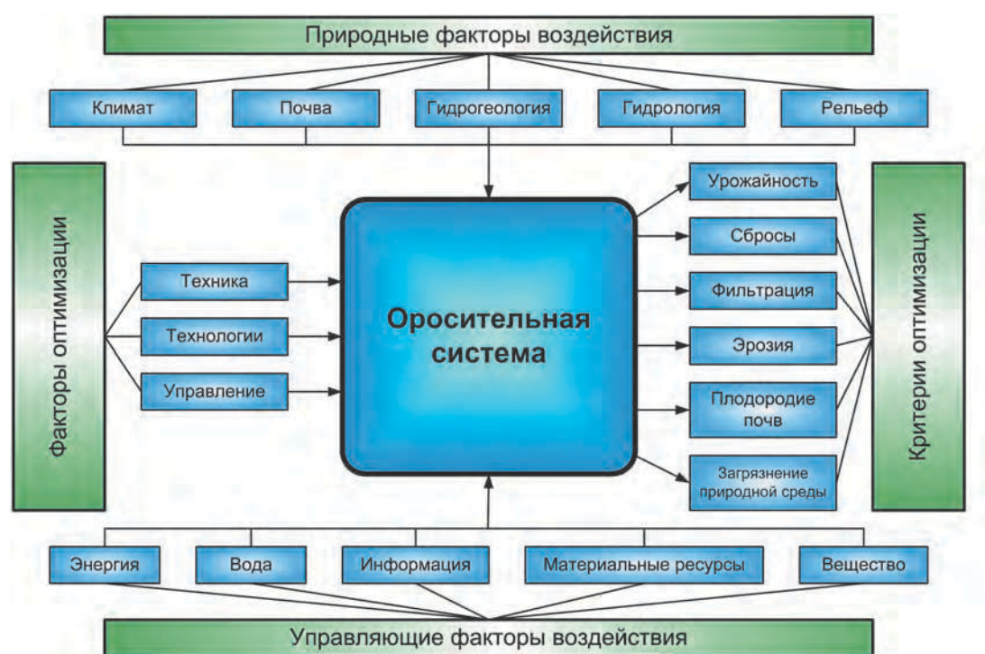
Рис. 1.1. Структурно-функциональная схема гидромелиоративной системы как сложного природно-технического объекта
