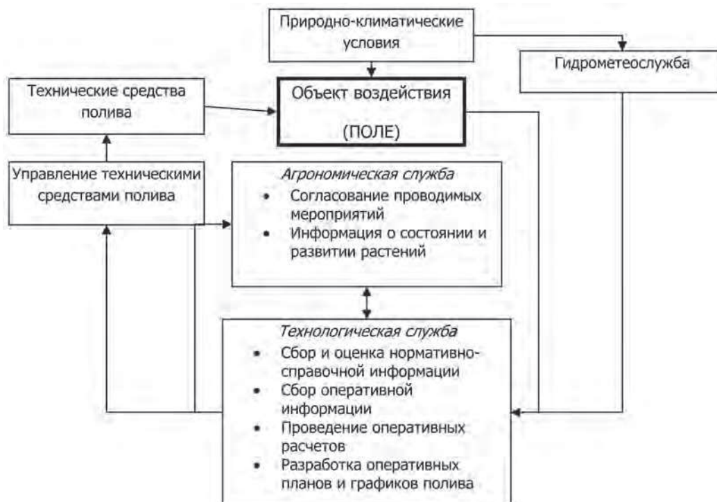
Рис.2.7. Структурно-функциональная схема оперативного управления поливами
