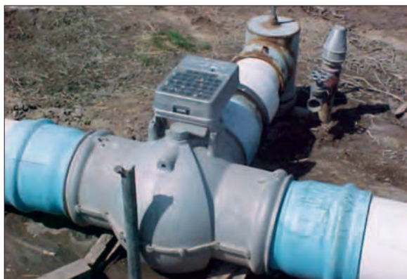
Рис. 9.5. Система дискретного (импульсного) полива с управляемым клапаном
