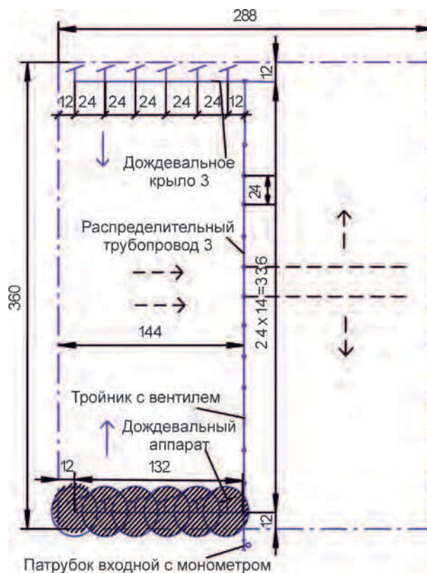
Рис. 5.3. Типовая схема орошения комплектом КИ-10 ( F_{op}=10,4 га)
