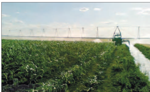
Рис. 3.37. Полив агрегатом ДДА-100МА
