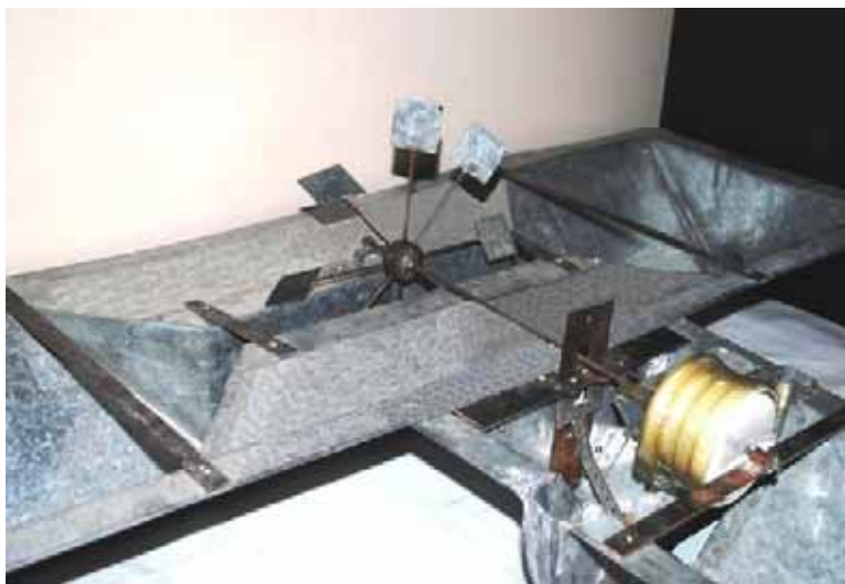
Рис. 22. Макет и схема водоподъёмника для дренажных вод
