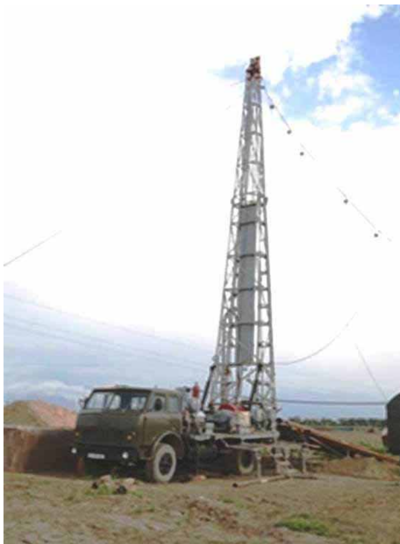
Рис. 16. Буровой агрегат УРБ-3АМ и схема бурения скважин методом прямой промывки.
