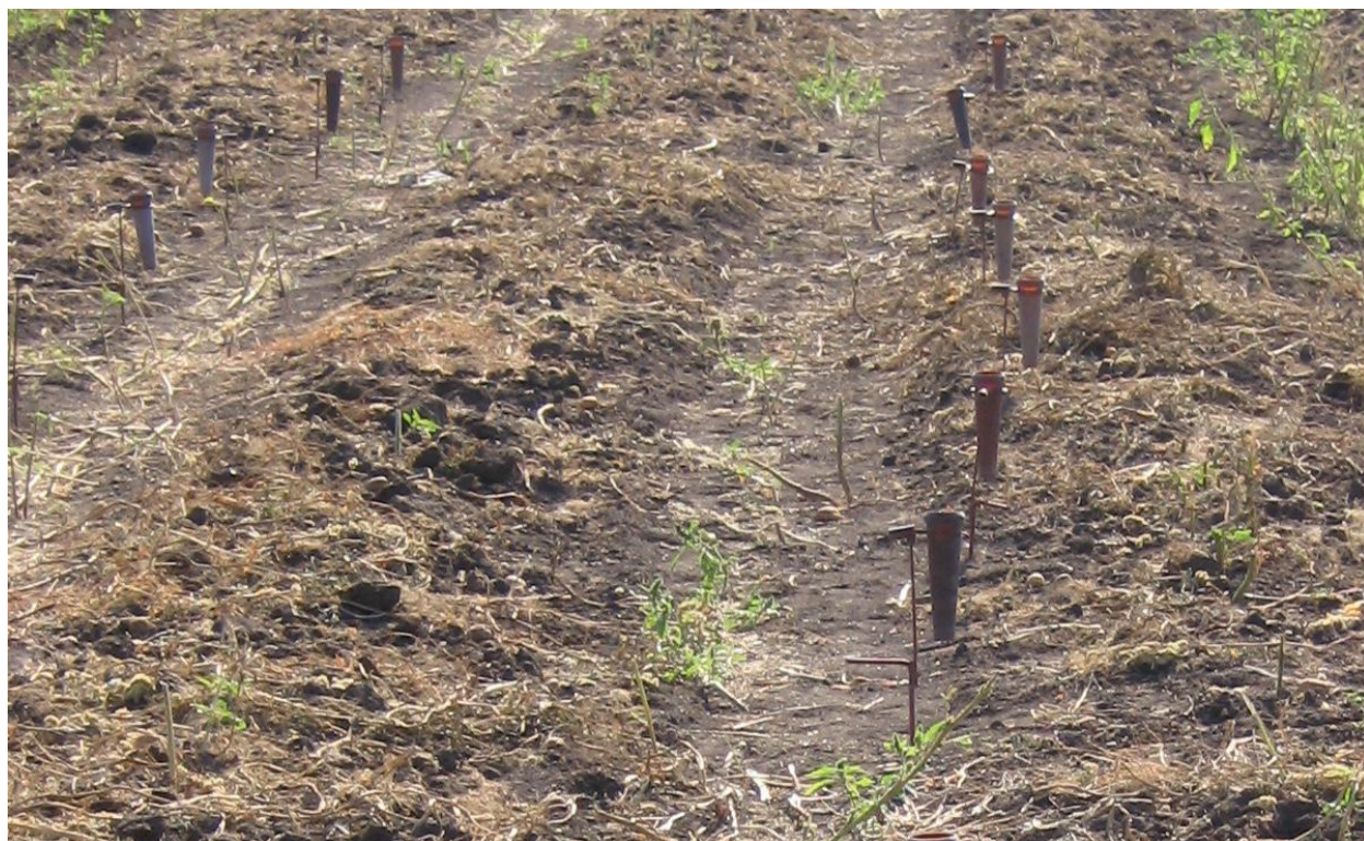
Рис. 10 Схема расстановки дождемерных бачков при поливе ДКФ-1ПК
