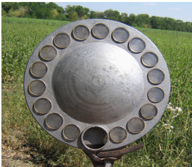
Рис. 12. Прибор для получения отпечатков водяных капель КР-2
