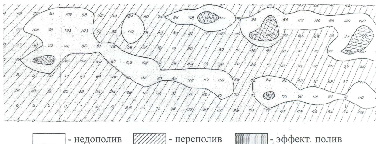
Рис. 17. Карта распределения искусственного дождя дождевальной машины ДКФ-1ПК – при рабочей высоте консоли 2 м
