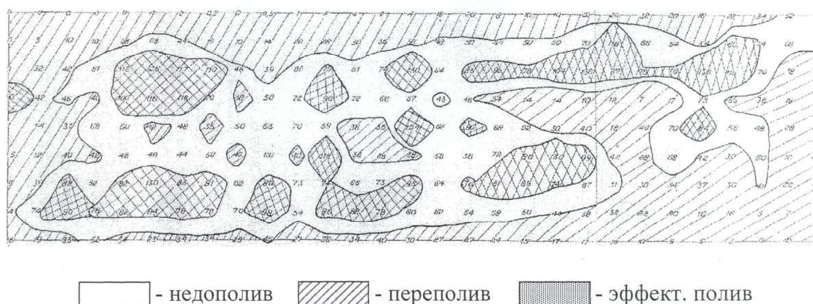
Рис. 17. Карта распределения искусственного дождя дождевальной машины ДКФ-1ПК – при рабочей высоте консоли 2 м
