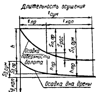
Рис. 59. Расчетная схема S=f(t) .
