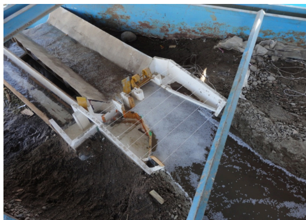
Рисунок 4.22 – Модель водозаборного сооружения для деривационных ГЭС
