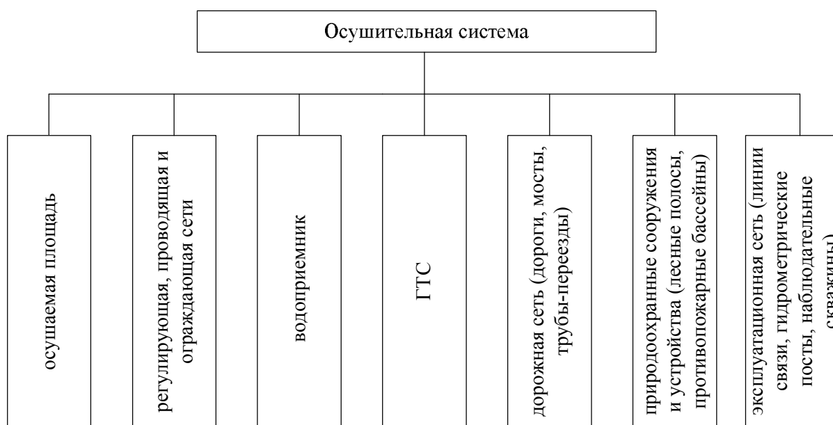
Рисунок 21 – Состав осушительной системы согласно Мелиоративной энциклопедии
