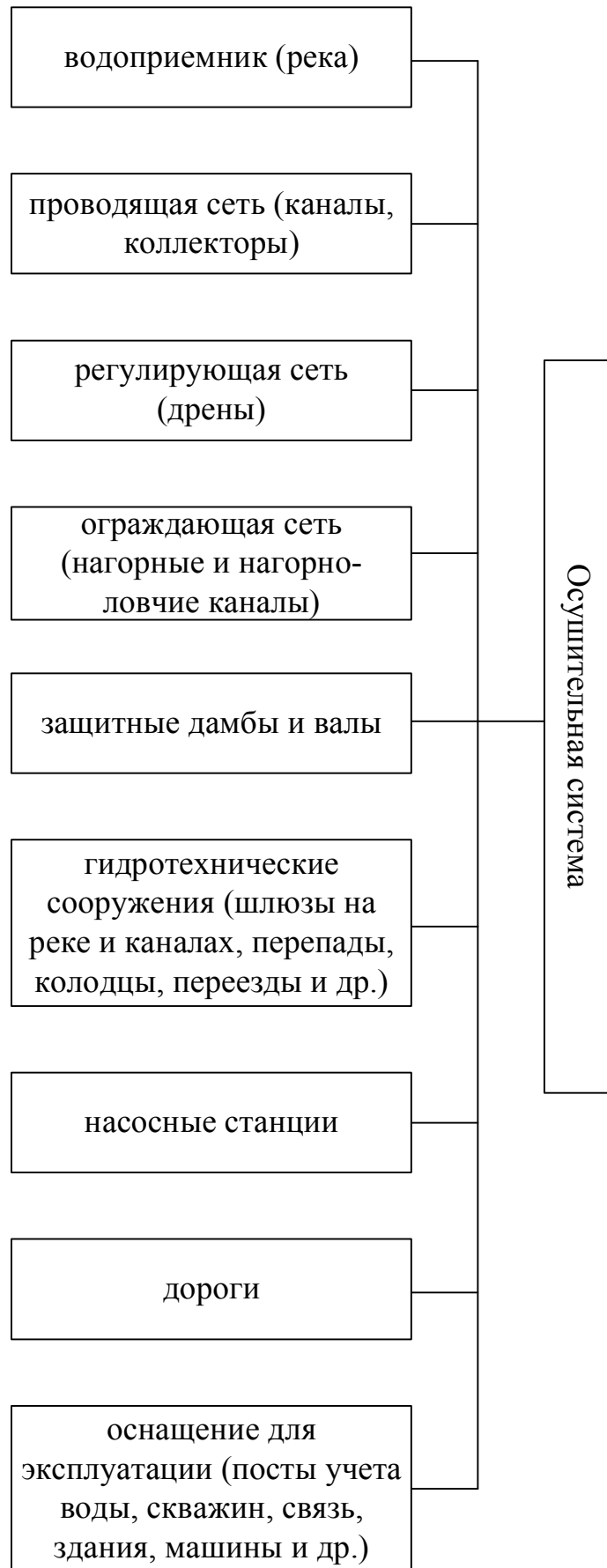
Рисунок 27 – Состав осушительной системы согласно М. Ф. Натальчук
