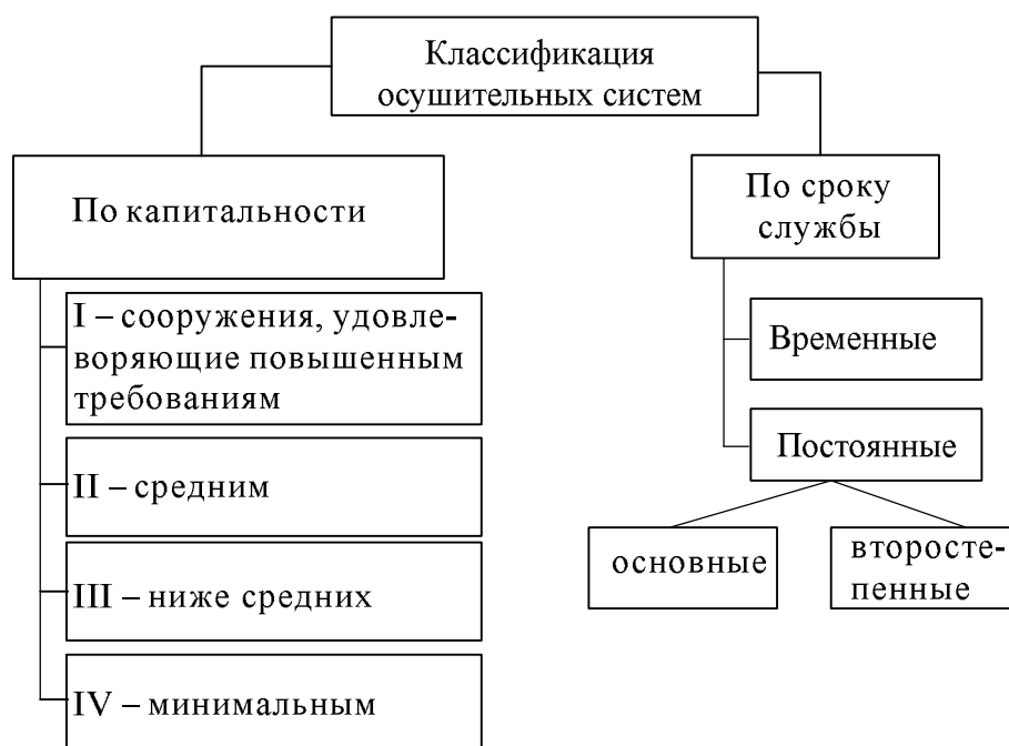
Рисунок 36 – Классификация осушительных систем согласно М. Н. Грацианскому
