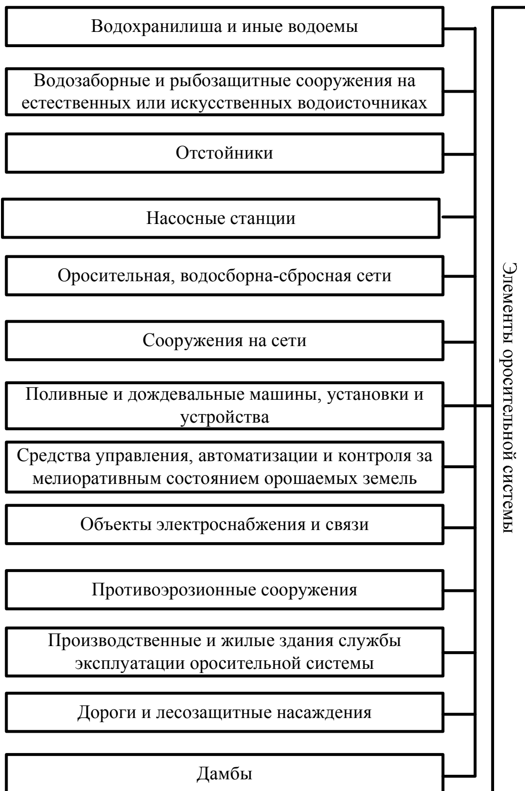
Рисунок 7 – Составные элементы оросительной системы согласно СНиП 2.06.03-85. Мелиоративные системы и сооружения
