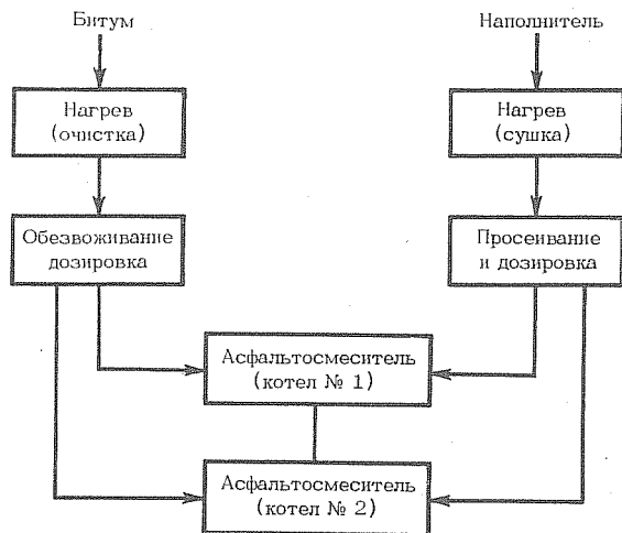
Рис. 5-3. Схема передвижного асфальто-битумного цеха
