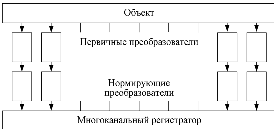
Рисунок 29 – Структурная схема многоканальной измерительной системы
