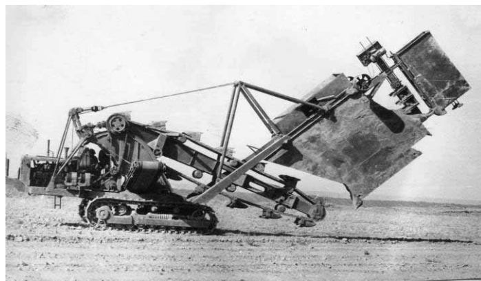
б) Дреноукладчик ЭД-3,0 с траншейным засыпателем-уплотнителем в транспортном положении
