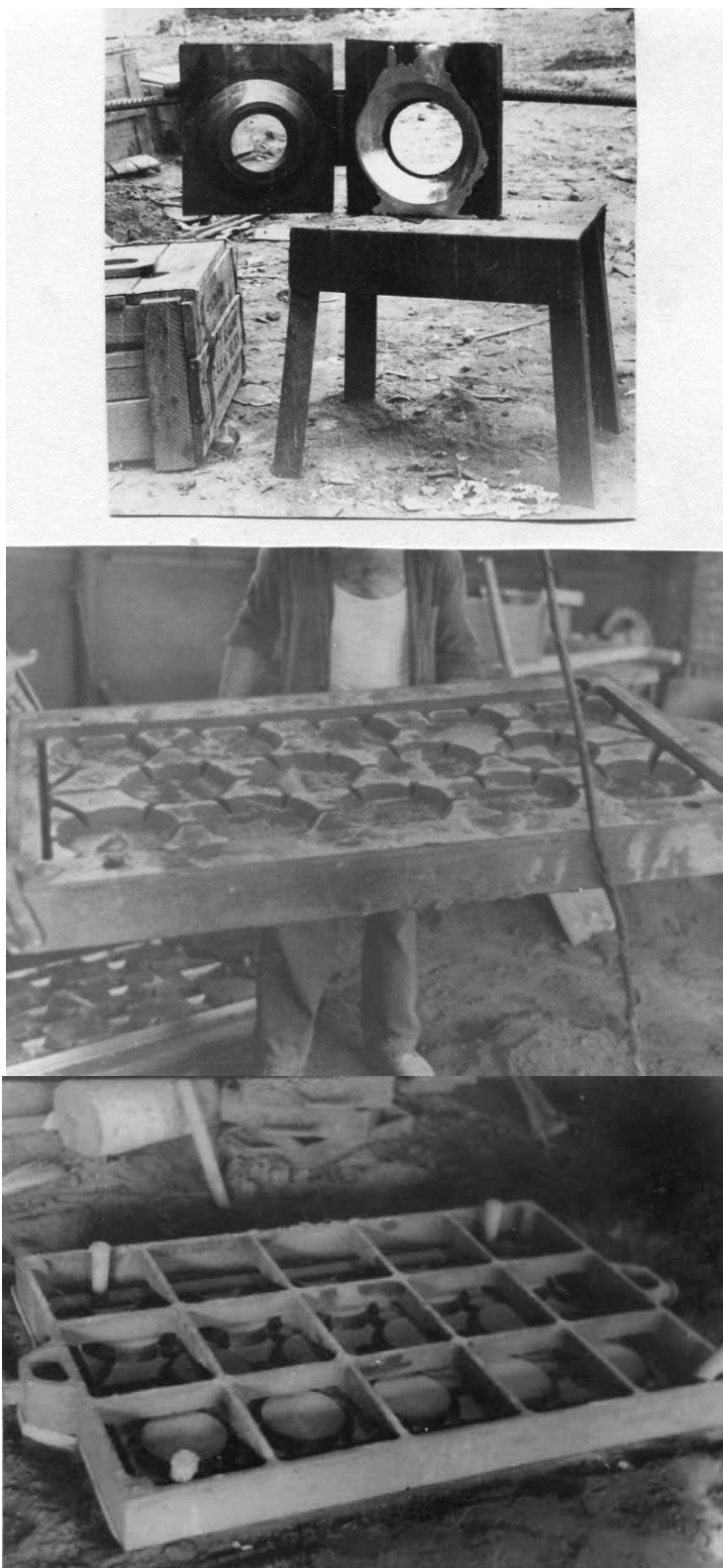
Рис. 3.9. Изготовление оснастки для отливки профильных поддонов на Янгиерском заводе
