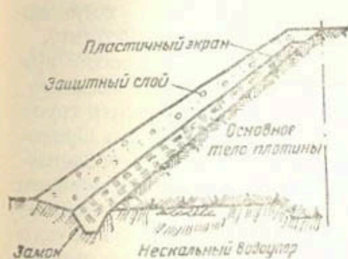
Рис. 38. Пластичный экран плотины на мягком водоупорном основании
