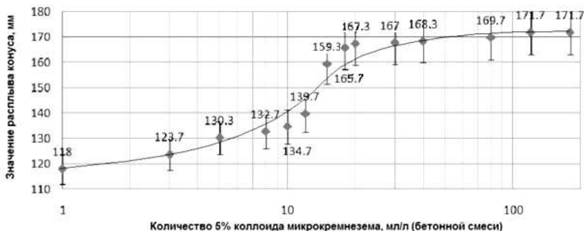
Рис. 3 - Влияние микроколичеств высокодисперсного микрокремнезема на подвижность модифицированной мелкозернистой бетонной смеси с при В/Ц=0,25 при добавлении гиперпластификатора MF5581(0,4% от ПЦ)
