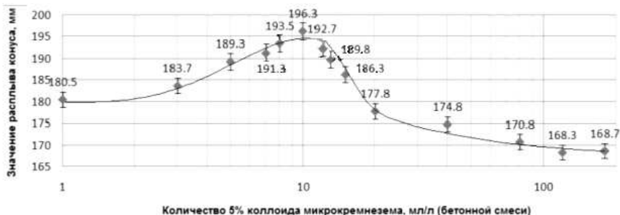
Рис. 2 - Влияние микроколичеств высокодисперсного микрокремнезема на подвижность модифицированной мелкозернистой бетонной смеси при В/Ц=0,4; без добавления гиперпластификатора MF5581
