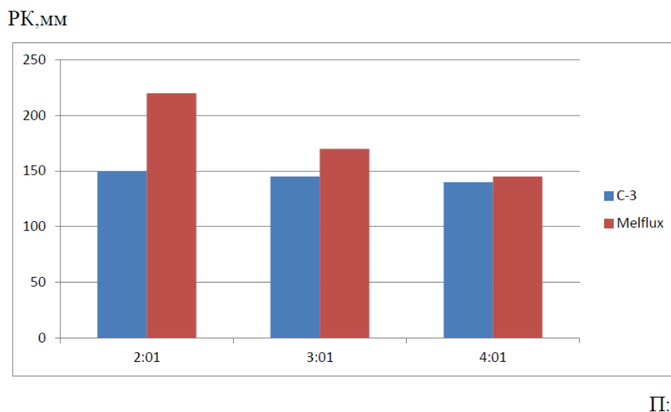
Рисунок 2 - Разжижающая способность СП и ГП в смесях на кварцевом песке
