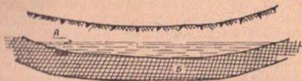
Рис. 8. Схема ненапорных грунтовых вод, встречающихся в природных условиях:
