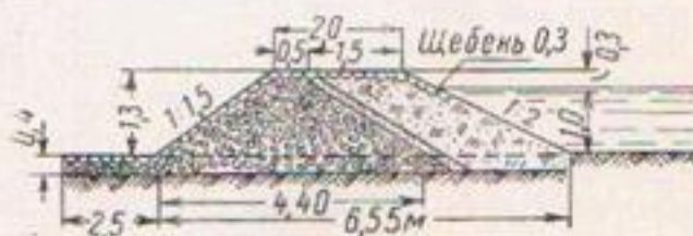
Рис. 201. Устройство перемычки из камня с земляной отсыпью.
