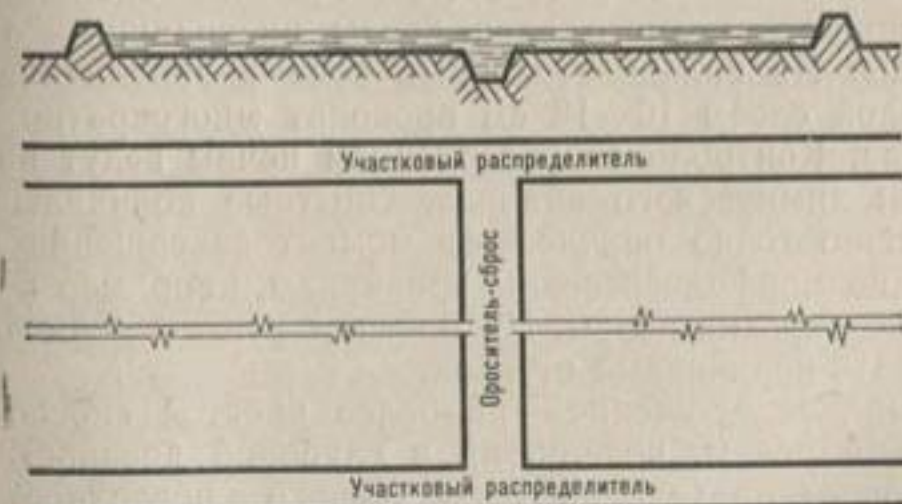
Рис. 10. Схема карты-чека широкого фронта залива.
